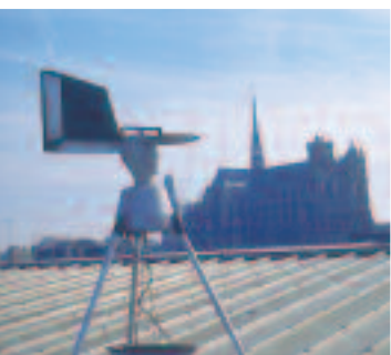
Le capteur de pollens installé sur le toit de la faculté des Sciences d'Amiens
